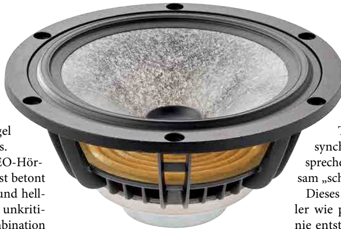
▲ Aus Gründen der Feinabstimmung ist der „Rohacel“-Kunstschaumkern des Mitteltöners nur einseitig mit Glasfaserfolie belegt.
