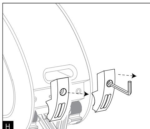
4. Dévissez les deux attaches avec la clé hexagonale.
