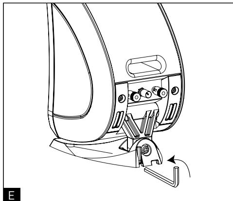
1. Utilisez la clé hexagonale fournie sous la base de Sib-T pour dévisser le socle et le séparer de l'enceinte.
