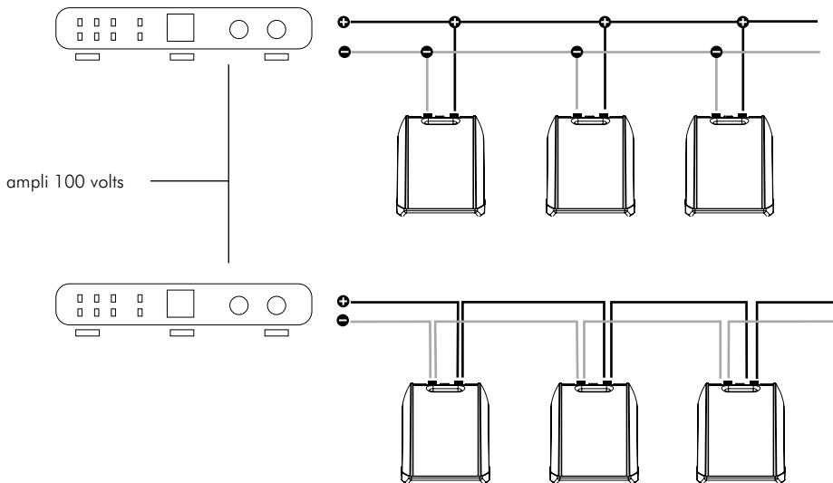
Le raccordement électrique en mode "4 Ω"
