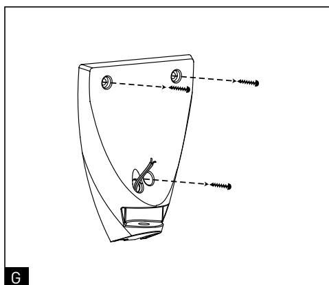
3. Placez le socle contre le mur et repérez les zones de perçage pour les trois vis de fixation fournies.
