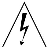
O símbolo de um relâmpago com uma ponta de seta, dentro de um triângulo equilátero, tem a intenção de alertar o utilizador para a presença de "tensão perigosa" não isolada dentro da caixa do produto, que pode ser de uma magnitude suficiente para constituir um risco de choque eléctrico às pessoas.
