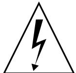
El símbolo del relámpago con punta de flecha, dentro de un triángulo equilátero, alerta al usuario de la presencia de una «tensión peligrosa» sin aislar en el interior del producto, que puede ser de la suficiente magnitud como para constituir un riesgo de descarga eléctrica para las personas.
