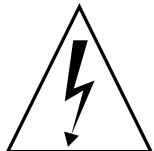
L'éclair représenté par le symbole flèche et contenu dans un triangle équilatéral, a pour objet de prévenir l'utilisateur de la présence de tension élevée au sein de l'appareil pouvant entraîner un risque de choc électrique.
