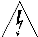
Il lampo con estremità a freccia contenuto in un triangolo equilatero rappresenta un allerta per l'utilizzatore, a significare la presenza di "corrente pericolosa" non isolata all'interno del cabinet del prodotto, corrente che potrebbe essere di magnitudine sufficiente a costituire un elemento di rischio di shock elettrico per le persone.
