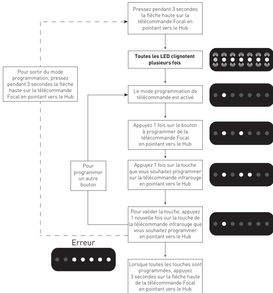
**Note :** Pour effacer la programmation sur la télécommande infrarouge, appuyez pendant 10 secondes sur la flèche haute de la télécommande Focal. Si aucune touche n'est pressée pendant 1 minute alors le mode de programmation deviendra inactif.
