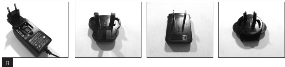
Raccordez le Hub au secteur à l'aide de l'alimentation fournie (n'utilisez pas une autre alimentation). Sur le Hub branchez l'alimentation sur la prise circulaire identifiée par le marquage "7.5 V == 1A" (*Fig. C*).
