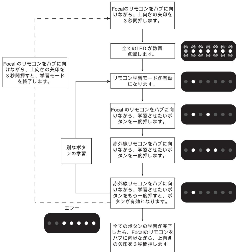
注：赤外線リモコンの学習登録を削除する場合は、Focal のリモコンの上向きの矢印を10秒間押します。1分間どのボタンも押されていない場合は、自動的に学習モードを終了します。
