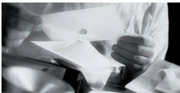
● Le sandwich composite "W", fabriqué à la main, tire son nom de "Verre-Verre", deux voiles de verre encadrant une mousse high-tech aux propriétés exceptionnelles.
